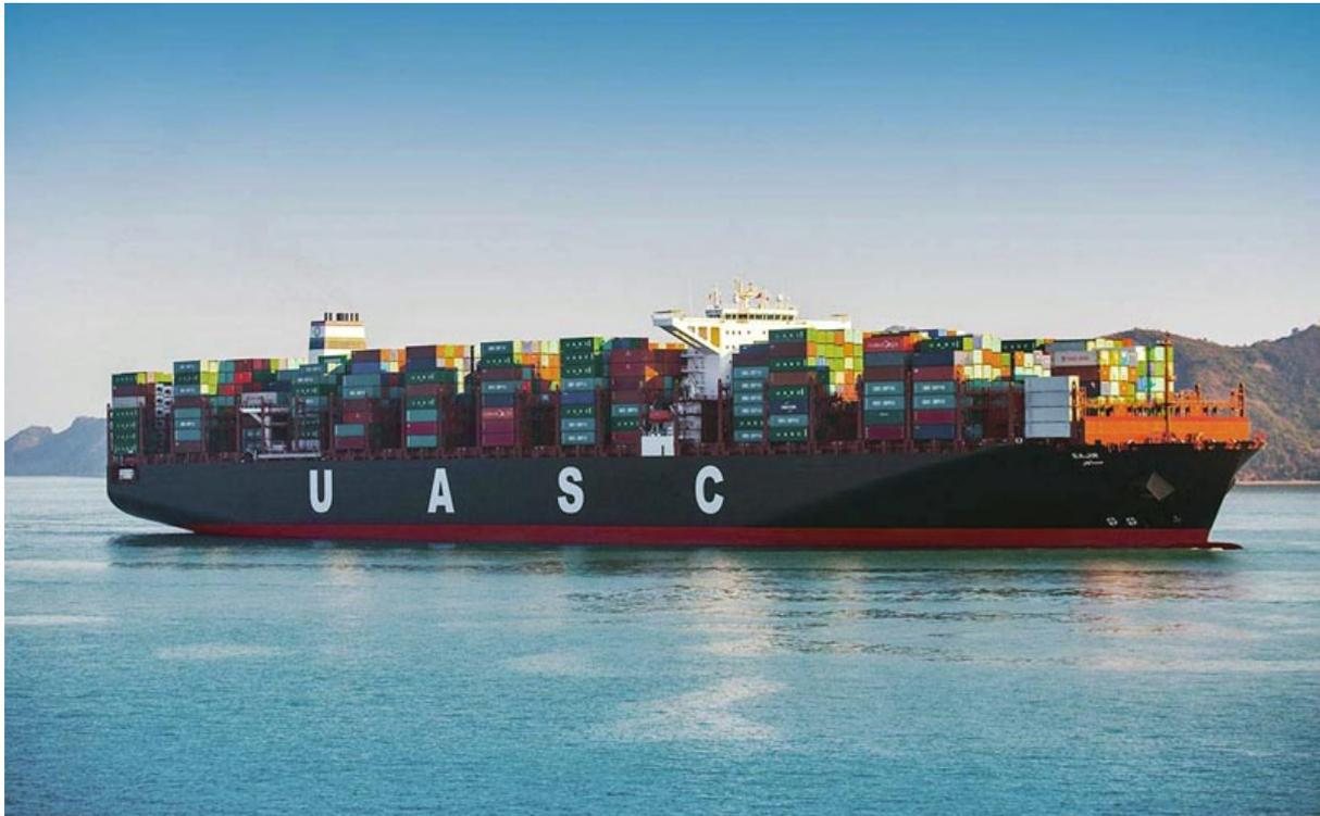
*Der Hapag-Lloyd/UASC-Boxcarrier "Sajir" (14 933 TEU) wird derzeit als weltweit erstes Großcontainerschiff auf die Möglichkeit, LNG als Brennstoff zu verwenden, umgerüstet. Andere Schiffe der Reederei erhalten Abgasreinigungsanlagen. "Diese Maßnahmen müssen sich langfristig bewähren", sagt der Hapag-Lloyd-Vorstandsvorsitzende Rolf Habben Jansen.*
